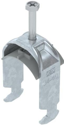
Staffa reggicavo con base a testa di martello, coppa in plastica di polipropilene. Per il montaggio verticale e orizzontale di 1 cavo singolo su profilato a C. Per dimensioni dell'asola di 16 - 17 mm. Con una vite sulla coppa premente, testa della vite esagonale universale da SW10, a taglio e a croce. Per il montaggio in ambienti interni ed esterni. Si consiglia di utilizzare una controcoppa.
