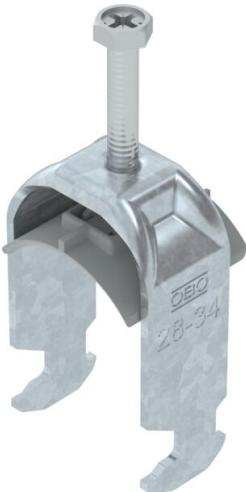
Bride de fixation avec pied tête de marteau, plaque de pression en matière plastique en polypropylène. Pour montage vertical et horizontal d'1 câble individuel sur des rails profilés en C. Pour une ouverture de 16 – 17 mm. Avec vis à 1 filet sur plaque de pression, tête de vis hexagonale universelle SW10, avec fente et empreinte cruciforme. Convient au montage en intérieur et en extérieur. L'utilisation d'une contre-plaque est recommandée.
