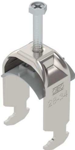
Staffa reggicavo con base a testa di martello, coppa in plastica di polipropilene. Per il montaggio verticale e orizzontale di 1 cavo singolo su profilato a C. Per dimensioni dell'asola di 16 - 17 mm. Con una vite sulla coppa premente, testa della vite esagonale universale da SW10, a taglio e a croce. Per il montaggio in ambienti interni ed esterni. Si consiglia di utilizzare una controcoppa.
