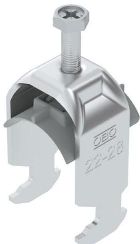
Staffa reggicavo con base a testa di martello, coppa in plastica di polipropilene. Per il montaggio verticale e orizzontale di 1 cavo singolo su profilato a C. Per dimensioni dell'asola di 16 - 17 mm. Con una vite sulla coppa premente, testa della vite esagonale universale da SW10, a taglio e a croce. Per il montaggio in ambienti interni ed esterni. Si consiglia di utilizzare una controcoppa.
