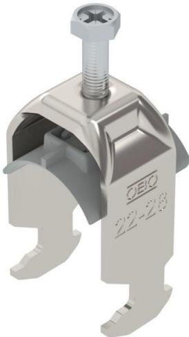
Staffa reggicavo con base a testa di martello, coppa in plastica di polipropilene. Per il montaggio verticale e orizzontale di 1 cavo singolo su profilato a C. Per dimensioni dell'asola di 16 - 17 mm. Con una vite sulla coppa premente, testa della vite esagonale universale da SW10, a taglio e a croce. Per il montaggio in ambienti interni ed esterni. Si consiglia di utilizzare una controcoppa.
