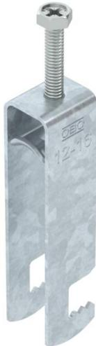
Bride de fixation avec pied F, plaque de pression métallique avec bords arrondis pour la protection des câbles. Pour montage vertical et horizontal de 3 câbles individuels sur des fers plats. Avec vis à 1 filet sur plaque de pression, tête de vis hexagonale universelle SW10, avec fente et empreinte cruciforme. Convient au montage en intérieur et en extérieur. Plusieurs câbles doivent être séparés par des plaques doubles. L'utilisation d'une contre-plaque est recommandée.
