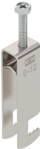
Staffa reggicavo ancoraggio tipo F, coppa in metallo con bordi arrotondati per proteggere il cavo. Per il montaggio verticale e orizzontale di 3 cavi singoli su profilo piatto. Con 1 vite a pressione, testa a vite esagonale universale SW10, con fessura e taglio a croce. Per il montaggio in ambienti interni ed esterni. Separazione tra due cavi grazie alla coppa doppia. Si consiglia di utilizzare una controcoppa.
