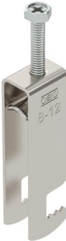
Bügelschelle mit F-Fuß, Metalldruckwanne mit gerundeten Kanten für Kabelschutz. Zur vertikalen und horizontalen Montage von 3 Einzelkabeln an Flacheisen. Mit 1-gängiger Schraube an Druckwanne, universeller Sechskant-Schraubkopf SW10, mit Schlitz und Kreuzschlitz. Geeignet für Montage im Innen- und Außenbereich. Mehrere Kabel sollten durch Doppelwannen getrennt werden. Der Einsatz einer Gegenwanne wird empfohlen.
