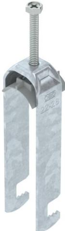
Bride de fixation avec pied F, plaque de pression en matière plastique en polypropylène. Pour montage vertical et horizontal de 3 câbles individuels sur des fers plats. Avec vis à 1 filet sur plaque de pression, tête de vis hexagonale universelle SW10, avec fente et empreinte cruciforme. Convient au montage en intérieur et en extérieur. Plusieurs câbles doivent être séparés par des plaques doubles. L'utilisation d'une contre-plaque est recommandée.
