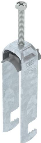
Bügelschelle mit F-Fuß, Kunststoffdruckwanne aus Polypropylen. Zur vertikalen und horizontalen Montage von 3 Einzelkabeln an Flacheisen. Mit 1-gängiger Schraube an Druckwanne, universeller Sechskant-Schraubenkopf SW10, mit Schlitz und Kreuzschlitz. Geeignet für Montage im Innen- und Außenbereich. Mehrere Kabel sollten durch Doppelwannen getrennt werden. Der Einsatz einer Gegenwanne wird empfohlen.
