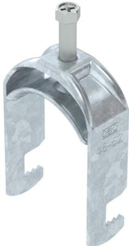
Staffa reggicavo ancoraggio tipo F, coppa in metallo con bordi arrotondati per proteggere il cavo. Per il montaggio verticale e orizzontale di 2 cavi singoli su profilo piatto. Con coppa di pressione, testa a vite esagonale universale SW10, intaglio a croce e a taglio. Per il montaggio in ambiente interno ed esterno. Separazione tra due cavi grazie alla coppa doppia. Si raccomanda l'uso della contro-coppa.
