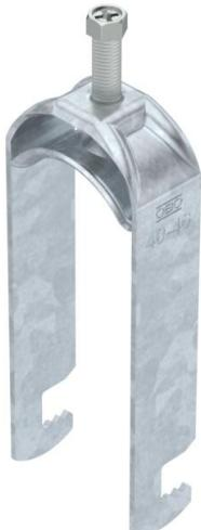
Staffa reggicavo ancoraggio tipo F, coppa in metallo con bordi arrotondati per proteggere il cavo. Per il montaggio verticale e orizzontale di 2 cavi singoli su profilo piatto. Con coppa di pressione, testa a vite esagonale universale SW10, intaglio a croce e a taglio. Per il montaggio in ambiente interno ed esterno. Separazione tra due cavi grazie alla coppa doppia. Si raccomanda l'uso della contro-coppa.
