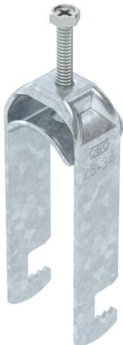
Staffa reggicavo ancoraggio tipo F, coppa in metallo con bordi arrotondati per proteggere il cavo. Per il montaggio verticale e orizzontale di 2 cavi singoli su profilo piatto. Con coppa di pressione, testa a vite esagonale universale SW10, intaglio a croce e a taglio. Per il montaggio in ambiente interno ed esterno. Separazione tra due cavi grazie alla coppa doppia. Si raccomanda l'uso della contro-coppa.
