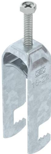
Staffa reggicavo ancoraggio tipo F, coppa in metallo con bordi arrotondati per proteggere il cavo. Per il montaggio verticale e orizzontale di 2 cavi singoli su profilo piatto. Con coppa di pressione, testa a vite esagonale universale SW10, intaglio a croce e a taglio. Per il montaggio in ambiente interno ed esterno. Separazione tra due cavi grazie alla coppa doppia. Si raccomanda l'uso della contro-coppa.
