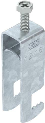
Staffa reggicavo ancoraggio tipo F, coppa in metallo con bordi arrotondati per proteggere il cavo. Per il montaggio verticale e orizzontale di 2 cavi singoli su profilo piatto. Con coppa di pressione, testa a vite esagonale universale SW10, intaglio a croce e a taglio. Per il montaggio in ambiente interno ed esterno. Separazione tra due cavi grazie alla coppa doppia. Si raccomanda l'uso della contro-coppa.
