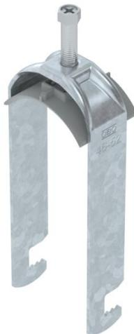
Staffa reggicavo con base a F, coppa in plastica di polipropilene. Per il montaggio verticale e orizzontale di 2 cavi singoli su profilato piatto. Con una vite sulla coppa premente, testa della vite esagonale universale da SW10, a taglio e a croce. Per il montaggio in ambienti interni ed esterni. Più cavi dovrebbero essere separati da coppe doppie. Si consiglia di utilizzare una controcoppa.
