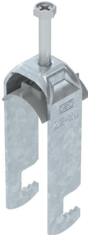
Bride de fixation avec pied F, plaque de pression en matière plastique en polypropylène. Pour montage vertical et horizontal de 2 câbles individuels sur des fers plats. Avec vis à 1 filet sur plaque de pression, tête de vis hexagonale universelle SW10, avec fente et empreinte cruciforme. Convient au montage en intérieur et en extérieur. Plusieurs câbles doivent être séparés par des plaques doubles. L'utilisation d'une contre-plaque est recommandée.
