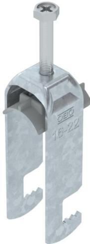
Staffa reggicavo con base a F, coppa in plastica di polipropilene. Per il montaggio verticale e orizzontale di 2 cavi singoli su profilato piatto. Con una vite sulla coppa premente, testa della vite esagonale universale da SW10, a taglio e a croce. Per il montaggio in ambienti interni ed esterni. Più cavi dovrebbero essere separati da coppe doppie. Si consiglia di utilizzare una controcoppa.
