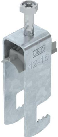
Bride de fixation avec pied F, plaque de pression en matière plastique en polypropylène. Pour montage vertical et horizontal de 2 câbles individuels sur des fers plats. Avec vis à 1 filet sur plaque de pression, tête de vis hexagonale universelle SW10, avec fente et empreinte cruciforme. Convient au montage en intérieur et en extérieur. Plusieurs câbles doivent être séparés par des plaques doubles. L'utilisation d'une contre-plaque est recommandée.
