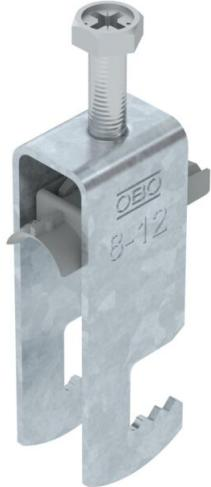
Staffa reggicavo con base a F, coppa in plastica di polipropilene. Per il montaggio verticale e orizzontale di 2 cavi singoli su profilato piatto. Con una vite sulla coppa premente, testa della vite esagonale universale da SW10, a taglio e a croce. Per il montaggio in ambienti interni ed esterni. Più cavi dovrebbero essere separati da coppe doppie. Si consiglia di utilizzare una controcoppa.
