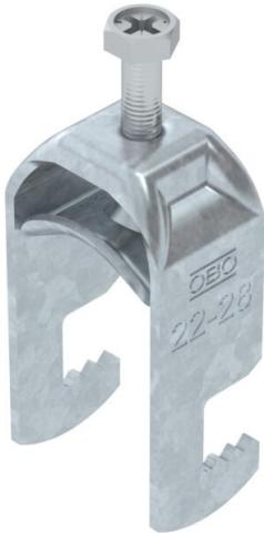
Staffa reggicavo con base a F, coppa in metallo con bordi arrotondati per proteggere il cavo. Per il montaggio verticale e orizzontale di 1 cavo singolo su profilato piatto. Con una vite sulla coppa premente, testa della vite esagonale universale da SW10, a taglio e a croce. Per il montaggio in ambienti interni ed esterni. Si consiglia di utilizzare una controcoppa.
