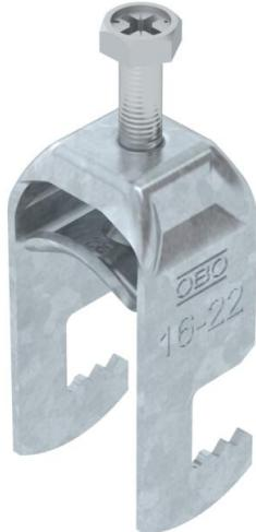
Staffa reggicavo con base a F, coppa in metallo con bordi arrotondati per proteggere il cavo. Per il montaggio verticale e orizzontale di 1 cavo singolo su profilato piatto. Con una vite sulla coppa premente, testa della vite esagonale universale da SW10, a taglio e a croce. Per il montaggio in ambienti interni ed esterni. Si consiglia di utilizzare una controcoppa.
