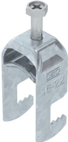
Bügelschelle mit F-Fuß, Metalldruckwanne mit gerundeten Kanten für Kabelschutz. Zur vertikalen und horizontalen Montage von 1 Einzelkabel an Flacheisen. Mit 1-gängiger Schraube an Druckwanne, universeller Sechskant-Schraubenkopf SW10, mit Schlitz und Kreuzschlitz. Geeignet für Montage im Innen- und Außenbereich. Der Einsatz einer Gegenwanne wird empfohlen.
