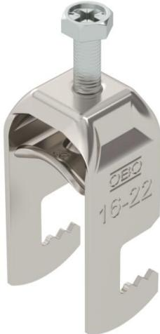
Staffa reggicavo con ancoraggio tipo F, coppa in metallo con bordi arrotondati a protezione del cavo. Per il montaggio verticale e orizzontale di 1 cavo singolo su profilato piatto. Dotata di vite SW10 per il serraggio della coppa tramite testa esagonale o intaglio a croce. Per il montaggio in ambiente interno ed esterno. Si raccomanda l'uso della controcoppa, da ordinare separatamente.
