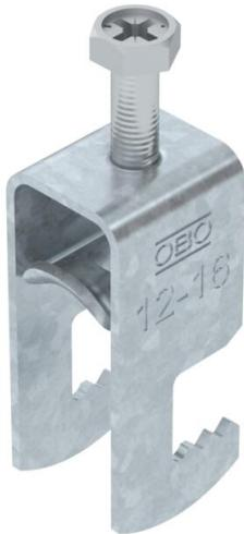
Staffa reggicavo con base a F, coppa in metallo con bordi arrotondati per proteggere il cavo. Per il montaggio verticale e orizzontale di 1 cavo singolo su profilato piatto. Con una vite sulla coppa premente, testa della vite esagonale universale da SW10, a taglio e a croce. Per il montaggio in ambienti interni ed esterni. Si consiglia di utilizzare una controcoppa.
