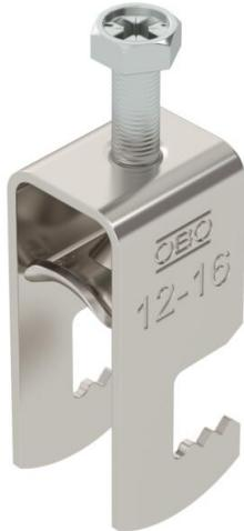
Staffa reggicavo con ancoraggio tipo F, coppa in metallo con bordi arrotondati a protezione del cavo. Per il montaggio verticale e orizzontale di 1 cavo singolo su profilato piatto. Dotata di vite SW10 per il serraggio della coppa tramite testa esagonale o intaglio a croce. Per il montaggio in ambiente interno ed esterno. Si raccomanda l'uso della controcoppa, da ordinare separatamente.
