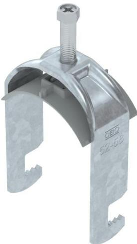
Staffa reggicavo con base a F, coppa in plastica di polipropilene. Per il montaggio verticale e orizzontale di 1 cavo singolo su profilato piatto. Con una vite sulla coppa premente, testa della vite esagonale universale da SW10, a taglio e a croce. Per il montaggio in ambienti interni ed esterni. Si consiglia di utilizzare una controcoppa.
