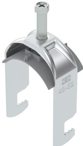
Staffa reggicavo ancoraggio tipo F, coppa in plastica in polipropilene. Per il montaggio verticale e orizzontale di 1 cavo singolo su profilato piatto. Con 1 vite a pressione, testa a vite esagonale universale SW10, con fessura e taglio a croce. Per il montaggio in ambienti interni ed esterni. Si consiglia di utilizzare una controcoppa.
