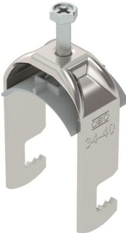
Bügelschelle mit F-Fuß, Kunststoffdruckwanne aus Polypropylen. Zur vertikalen und horizontalen Montage von 1 Einzelkabel an Flacheisen. Mit 1-gängiger Schraube an Druckwanne, universeller Sechskant-Schraubenkopf SW10, mit Schlitz und Kreuzschlitz. Geeignet für Montage im Innen-und Außenbereich. Der Einsatz einer Gegenwanne wird empfohlen.
