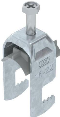
Staffa reggicavo con base a F, coppa in plastica di polipropilene. Per il montaggio verticale e orizzontale di 1 cavo singolo su profilato piatto. Con una vite sulla coppa premente, testa della vite esagonale universale da SW10, a taglio e a croce. Per il montaggio in ambienti interni ed esterni. Si consiglia di utilizzare una controcoppa.
