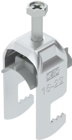
Bride de fixation avec pied F, plaque de pression en matière plastique en polypropylène. Pour montage vertical et horizontal d'1 câble individuel sur des fers plats. Avec vis à 1 filet sur plaque de pression, tête de vis hexagonale universelle SW10, avec fente et empreinte cruciforme. Convient au montage en intérieur et en extérieur. L'utilisation d'une contre-plaque est recommandée.
