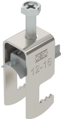
Bügelschelle mit F-Fuß, Kunststoffdruckwanne aus Polypropylen. Zur vertikalen und horizontalen Montage von 1 Einzelkabel an Flacheisen. Mit 1-gängiger Schraube an Druckwanne, universeller Sechskant-Schraubenkopf SW10, mit Schlitz und Kreuzschlitz. Geeignet für Montage im Innen- und Außenbereich. Der Einsatz einer Gegenwanne wird empfohlen.
