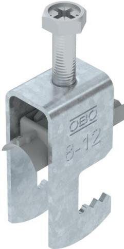
Staffa reggicavo con base a F, coppa in plastica di polipropilene. Per il montaggio verticale e orizzontale di 1 cavo singolo su profilato piatto. Con una vite sulla coppa premente, testa della vite esagonale universale da SW10, a taglio e a croce. Per il montaggio in ambienti interni ed esterni. Si consiglia di utilizzare una controcoppa.
