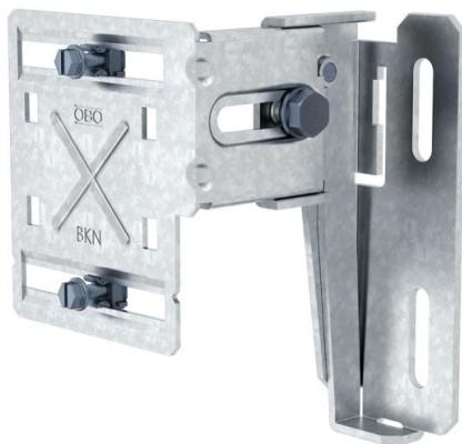
Befestigungskonsole zur Montage von Geräteeinbaukanälen an Brüstungskonstruktionen und als Auflage für Konvektionsgitter. Die Befestigungskonsole ist für alle Rapid 80 Geräteeinbaukanalsysteme vom Typ GK und GA einsetzbar. Für die Montage von GK Geräteeinbaukanälen aus Kunststoff wird zusätzlich der passende Wandkonsolenadapter benötigt. Für die Montage von Doppelkanälen Typ GS-D70170 und GS-D90170 sowie für GS Kanäle mit 210 mm Nennbreite wird das Verbindungsprofil benötigt.
