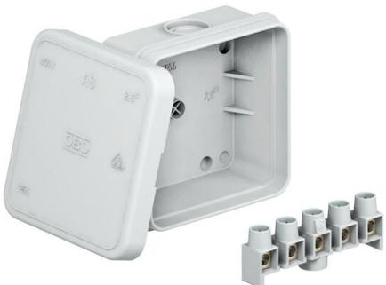
Type de protection IP55, tension nominale 690 V, section nominale 2,5 mm<sup>2</sup>, 12 entrées pour diamètres de câble de 5 à 14 mm.
