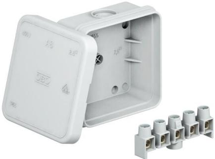
Schutzart IP55, Nennspannung 690 V, Nennquerschnitt 2,5 mm<sup>2</sup>, 7 Einführungen für Kabeldurchmesser 5-14 mm.
