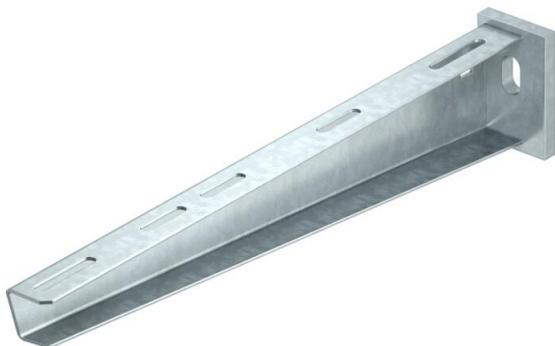
Mensola medio-pesante a parete e a profilato con piastra di supporto saldata. Fissaggio della mensola al profilato a U a partire dalla larghezza di 400 mm con vite a testa esagonale attraverso entrambi i longheroni del profilato. Si prega di impiegare i distanziatori adatti allo scopo.
