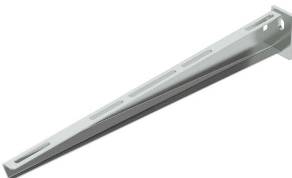
Console murale et de pendard légère avec plaque de tête soudée. Pour le montage de la console sur des pendards en U, il convient d'utiliser pour la fixation de la console de montant une vis à tête bombée ou une vis à tête hexagonale, selon le profilé, jusqu'à une largeur de 400 mm. À partir d'une largeur de 500 mm, la console est fixée à travers les deux longerons du pendard en U à l'aide de vis à tête hexagonale. Il convient en outre d'utiliser l'entretoise adaptée, en fonction du profilé.
