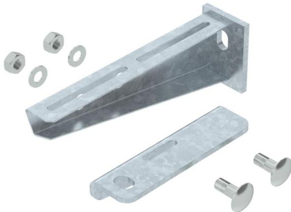
Ausleger zur Montage an Hängestielen oder als Wandausleger für die Verlegeart mit Kabelrinnen oberhalb von Brandschutzdecken und bei den Verlegearten mit Kabelleitern und Kabelrinnen für den Funktionserhalt nach DIN 4102 Teil 12. Die Ausleger werden fertig montiert geliefert.
