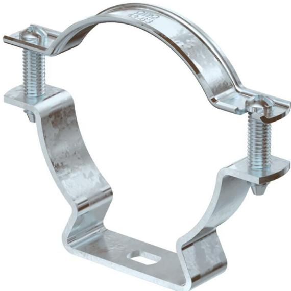
Abstandschelle zur Montage von Rohren und Kabeln an Wand, Decke und Boden. Mit selbstsicherndem Oberteil. Befestigung über Langloch. Zugelassen für den Funktionserhalt nach DIN 4102 Teil 12, Funktionserhaltklassen E 30 bis E 90.
