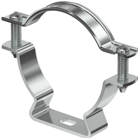
Collier d'écartement pour le montage de tubes et câbles au mur, au plafond et au sol. Avec partie supérieure autobloquante. Fixation par trou oblong. A partir de la taille 20 des colliers, convenant au montage avec clouer ou pistolet de scellement.
