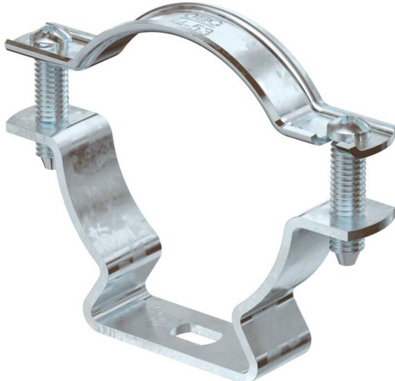
Abstandschelle zur Montage von Rohren und Kabeln an Wand, Decke und Boden. Mit selbstsicherndem Oberteil. Befestigung über Langloch. Zugelassen für den Funktionserhalt nach DIN 4102 Teil 12, Funktionserhaltklassen E 30 bis E 90.
