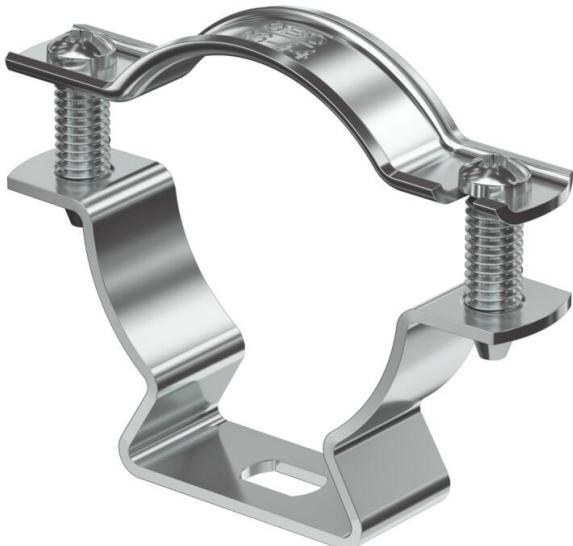
Collier d'écartement pour le montage de tubes et câbles au mur, au plafond et au sol. Avec partie supérieure autobloquante. Fixation par trou oblong. A partir de la taille 20 des colliers, convenant au montage avec clouer ou pistolet de scellement.
