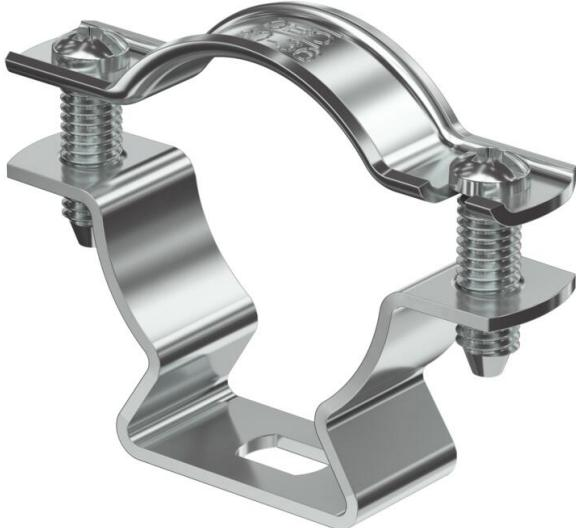
Collier d'écartement pour le montage de tubes et câbles au mur, au plafond et au sol. Avec partie supérieure autobloquante. Fixation par trou oblong. A partir de la taille 20 des colliers, convenant au montage avec clouer ou pistolet de scellement.
