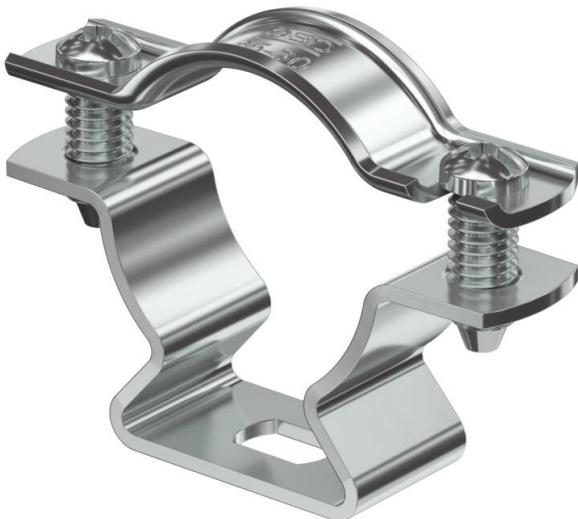
Abstandschelle zur Montage von Rohren und Kabeln an Wand, Decke und Boden. Mit selbstsicherndem Oberteil. Befestigung über Langloch. Ab der Schellengröße 20 geeignet für Montage mit Nagelgerät oder Bolzensetzgerät. Zugelassen für den Funktionserhalt nach DIN 4102 Teil 12, Funktionserhaltklassen E 30 bis E 90 (außer ALU).
