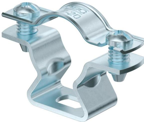
Abstandschelle zur Montage von Rohren und Kabeln an Wand, Decke und Boden. Mit selbstsicherndem Oberteil. Befestigung über Langloch. Zugelassen für den Funktionserhalt nach DIN 4102 Teil 12, Funktionserhaltklassen E 30 bis E 90.
