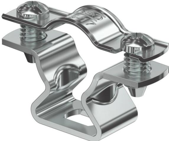
Collier d'écartement pour le montage de tubes et câbles au mur, au plafond et au sol. Avec partie supérieure autobloquante. Fixation par trou oblong. A partir de la taille 20 des colliers, convenant au montage avec clouer ou pistolet de scellement.
