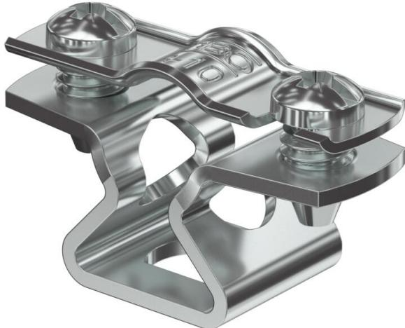
Collier d'écartement pour le montage de tubes et câbles au mur, au plafond et au sol. Avec partie supérieure autobloquante. Fixation par trou oblong. A partir de la taille 20 des colliers, convenant au montage avec cloueur ou pistolet de scellement.
