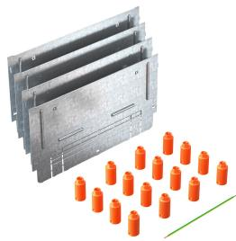
Set di montaggio per scatole da incasso UZD250-4 con una altezza da 240 a 320 mm per elevare l'altezza di UZD.
