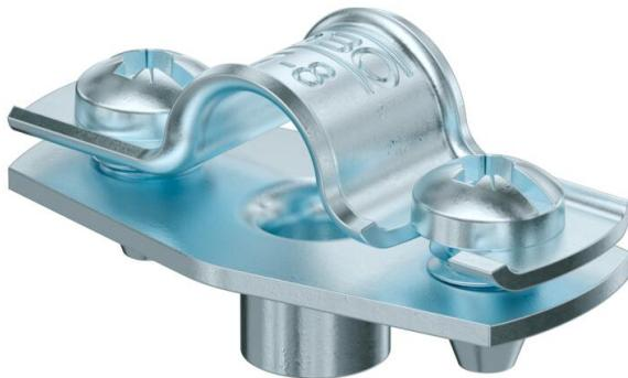
Abstandschelle zur Montage von Rohren und Kabeln an Wand, Decke und Boden. Mit selbstsicherndem Oberteil. Befestigung über Ansatz mit Innengewinde. Zugelassen für den Funktionserhalt nach DIN 4102 Teil 12, Funktionserhaltklassen E 30 bis E 90.
